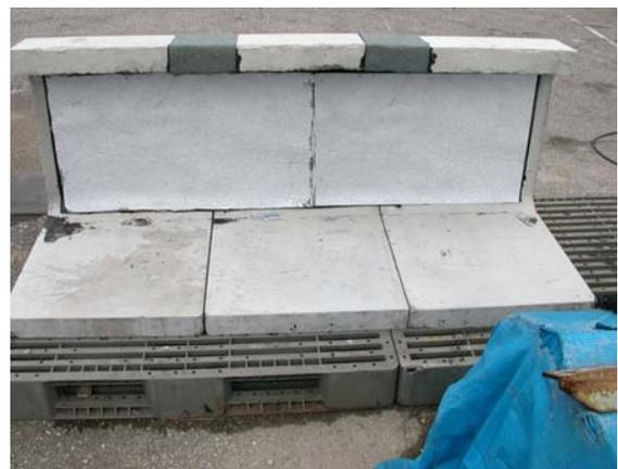
露出アスファルト防水試験体
